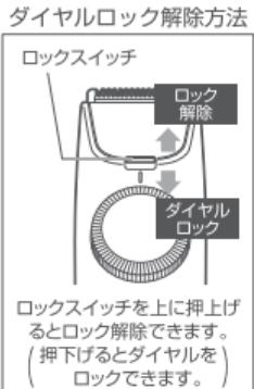
長さ調節後は、ロックスイッチを操作してダイヤルをロックすることで、使用時に意図せずダイヤルに触れて長さが変わることを防げます。
